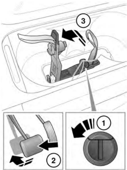
1. Поверните механизм блокировки на 90° против часовой стрелки.
