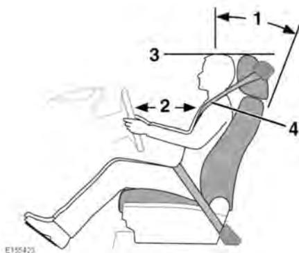
1. Сядьте прямо. При этом поясница должна плотно прилегать к спинке сиденья. Чтобы обеспечить оптимальную защиту с помощью ремня безопасности в случае ДТП, не наклоняйте спинку сиденья слишком сильно назад.
