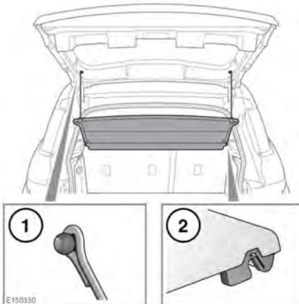
Снятие крышки багажного отделения:
