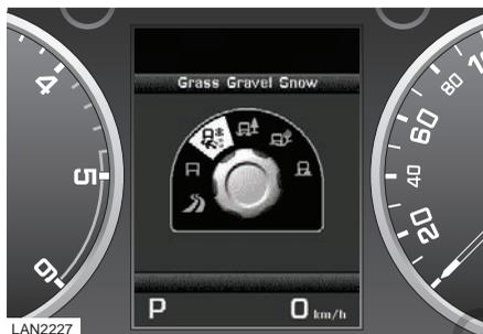
Указатели температуры и топлива на информационной панели будут временно заменены на органы управления системой Terrain Response. Текущая программа отображается белым значком на черном фоне.
