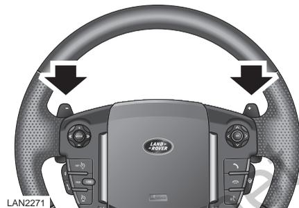
Выбор передач с помощью системы CommandShift можно также осуществлять лопаточными переключателями на рулевом колесе; данная система оптимизирована для ускорения реакции на запрос переключения передачи.
