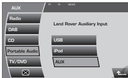
Для прослушивания источника, подключенного к входу для дополнительных устройств, подсоедините это устройство к стереовходу 3,5 мм, помеченному маркировкой **AUX**.
