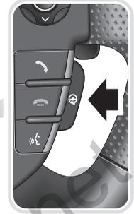
Потяните переключатель, чтобы включить или выключить подогрев. Значок обогрева рулевого колеса подсвечивается в следующем режиме:
