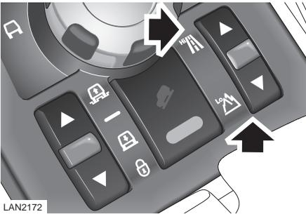
Раздаточная коробка допускает включение передач повышенного или пониженного диапазона.
