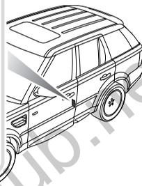
Идентификационный номер автомобиля (VIN) и рекомендуемые максимальные массы автомобиля проштампованы на пластине, прикрепленной к замковой стороне проема левой (для Китая – правой) передней двери, в нижней части. Номер VIN должен совпадать с номером VIN, записанным в сервисной книжке, и с номером VIN, который видно через ветровое стекло.
