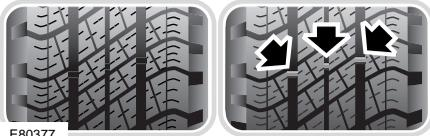
Когда протектор изнашивается примерно до 2 мм, на его поверхности появляется индикатор износа. Он представляет собой резиновую ленту, проходящую через весь протектор, и служит визуальным указателем.
