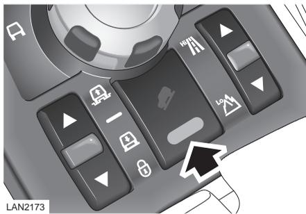
Для включения HDC нажмите и отпустите переключатель (указан стрелкой), при этом загорится сигнализатор HDC. Для отключения нажмите переключатель снова и отпустите (индикатор погаснет).
