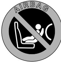
Этот символ крепится на торце приборной панели со стороны пассажира. Он означает, что запрещается использовать детское кресло, в котором ребёнок сидит лицом назад, при установленной и действующей подушке безопасности переднего пассажира.
