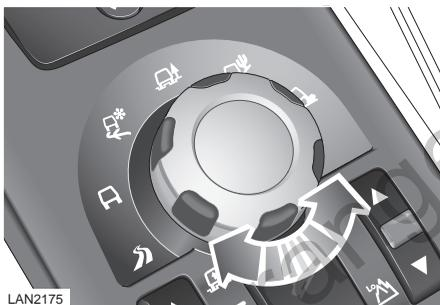
При включении зажигания один из индикаторов рядом с регулятором загорится янтарным цветом, указывая текущую программу. Индикатор специальной программы отобразится также на информационной панели.
