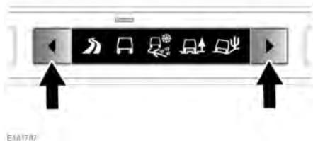
Управление системой Terrain Response выполняется при помощи кнопок на центральной консоли. См. 416, **ОРГАНЫ УПРАВЛЕНИЯ** С помощью кнопок можно выбрать одну из имеющихся программ. Значок выбранной программы отображается на информационной панели и включается соответствующий светодиодный индикатор.
