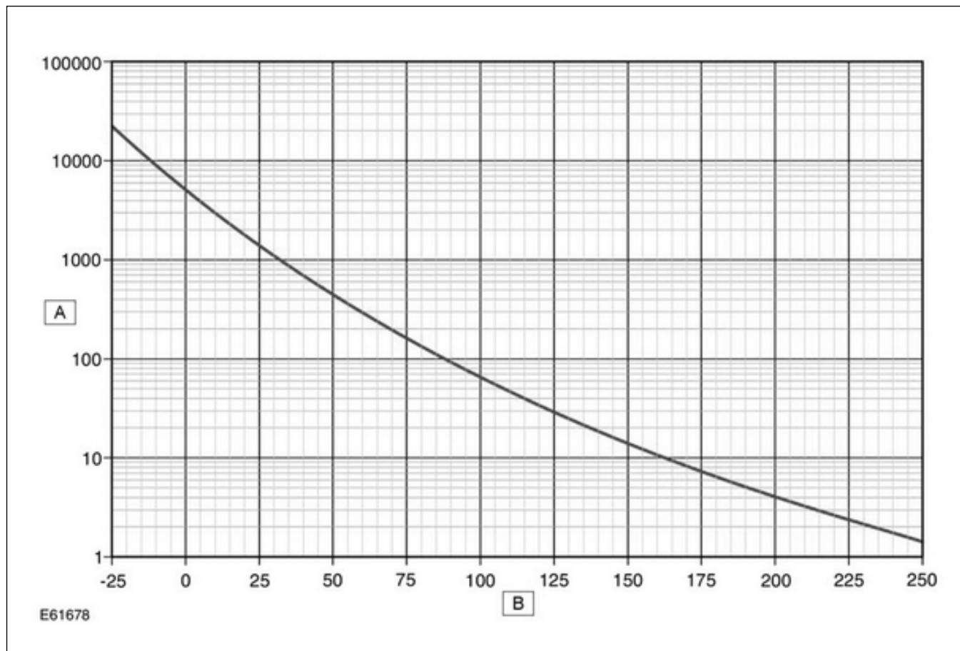
Следующий график показывает соответствие сигнала входного напряжения на электронном блоке управления пневмоподвеской от датчика температуры электродви-
