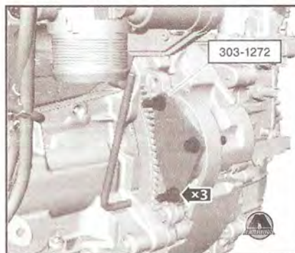
12. Установите инструмент для блокировки коленчатого вала. Специальный инструмент(ы): 303-1272.
