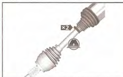
7. Установить левый приводной вал (полуось) в ступицу колеса и корпус коробки передач (см. главу Ходовая часть).
