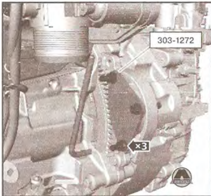
7. Снимите инструмент для синхронизации коленчатого вала. Специальный инструмент(ы): 303-1270.
