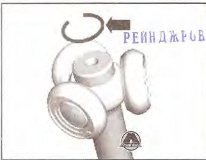
5. Установить специальное приспособление (съемник - 303-D121), на приводной вал и спрессовать трипод (тришип), как показано на рисунке ниже.
