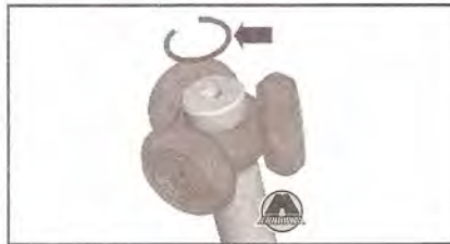
4. Совместить нанесенные при разборке метки и установить трипод в корпус шарнира равных угловых скоростей, как показано на рисунке ниже.
