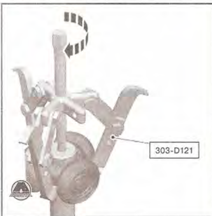
5. Установить специальное приспособление (съемник - 303-D121), на приводной вал и спрессовать трипод (тришип), как показано на рисунке ниже.
