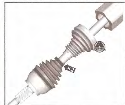
4. Установить пыльник внутреннего шарнира равных угловых скоростей.
