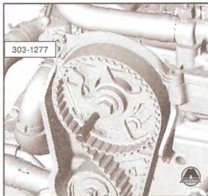
9. Проверните двигатель на десять полных оборотов по часовой стрелке. 10. Установите приспособление установки момента впрыска. Специальный инструмент(ы): 303-1270.
