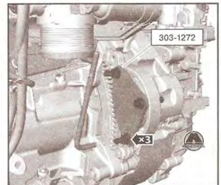
18. Снимите инструмент для синхронизации коленчатого вала. Специальный инструмент(ы): 303-1270.
