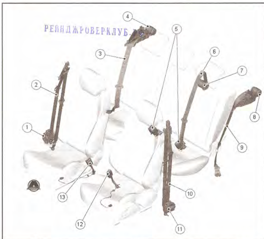
1. Инерционный барабан переднего RH (правый) ремня безопасности 2. Передний RH ремень безопасности 3. Задний RH ремень безопасности 4. Инерционный барабан заднего RH ремня безопасности 5. Замок заднего ремня безопасности 6. Центральный ремень безопасности 7. Инерционный барабан центрального ремня безопасности 8. Инерционный барабан заднего LH (левый) ремня безопасности 9. Задний LH ремень безопасности 10. Передний LH ремень безопасности 11. Инерционный барабан переднего LH ремня безопасности 12. Замок переднего LH ремня безопасности 13. Замок переднего RH ремня безопасности
