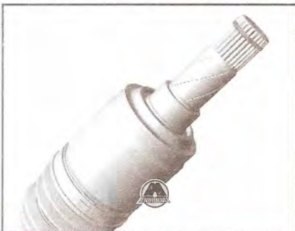
11. Извлечь из корпуса главной передачи уплотнительную манжету, показанную на рисунке ниже.
