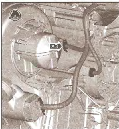
18. Высвободить из зажимов жгуты электропроводки, как показано на рисунке ниже.
