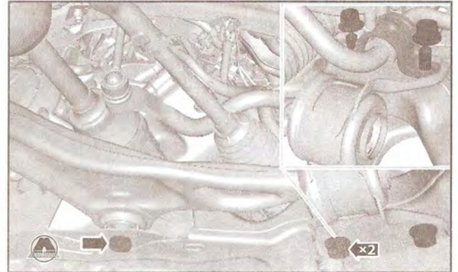
14. Подпереть подрамник в сборе, используя специальный гидравлический домкрат, как показано на рисунке ниже.
