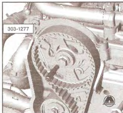
12. Установите инструмент для блокировки коленчатого вала. Специальный инструмент(ы): 303-1272.
