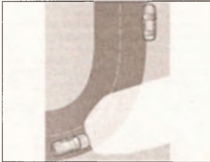
Направление света фар на автомобилях без системы AFS.
